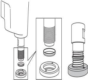
**AVISO** El taco antifricción sirve para evitar que se dañe el eje y la caja de transmisión al desmontar la broca.
